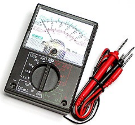
三用電表VAC檔 量測電壓
